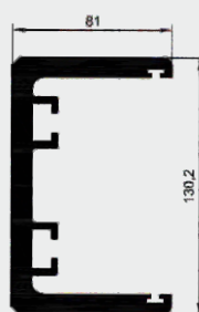
VODILNA TIRNICA > lateralna vodilna tirnica iz aluminija
